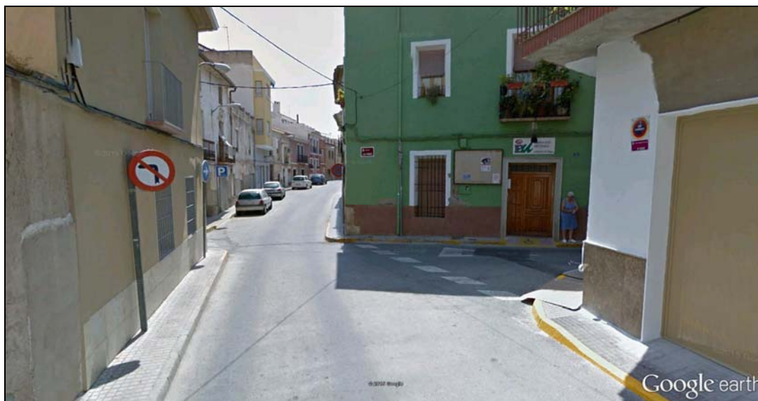
28.- Cruce de la calle Vereda con la calle Cruz. Continuamos con la estrechez de aceras. Se observa la existencia de vado rodado con placa y licencia en vigor en lado derecho y cruce aéreo de Telefónica que se soterrará.
