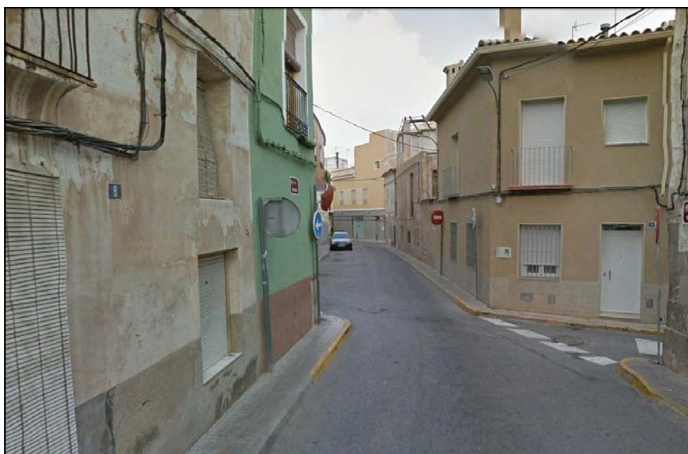
29.- Cruce de la calle Vereda con la calle Cruz visto en oposición de la fotografía 28. Continuamos con la estrechez de aceras y la falta de alineación de fachadas. Se observa un cruce aéreo de Iberdrola que se ejecutará cuando se urbanice la calle Cruz.
