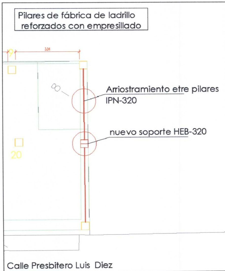
imagen. refuerzo mediante arriostramiento intermedio de fachada sureste.
