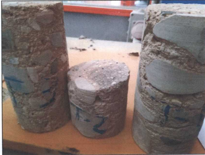
imagen. Testigos de cimentación
